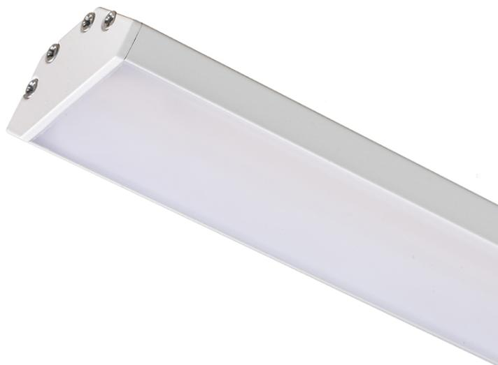
Perfil de esquina de aluminio para colocar tiras de LED adecuadas. Se pueden colocar hasta tres tiras LED de 8 mm de ancho o dos tiras LED de 12 mm de ancho. Se suministra con un difusor mate y accesorios.
