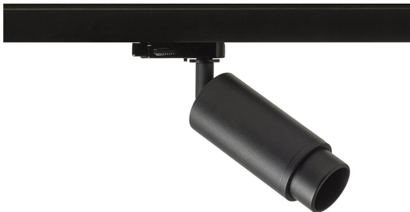
Spot cylindrique pour rail triphasé, avec réglage du faisceau lumineux via un système de zoom 10–50°. Compatible avec les sources LED à culot GU10. Utilisez des sources avec un angle de diffusion de 120° pour éviter les ombres indésirables.
