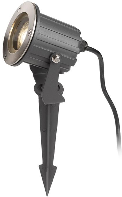
Außenstrahler aus Aluminium mit Edrspieß, GU10-Fassung und Frontplatte aus Edelstahl. Inklusive 1 m Anschlusskabel ohne Stecker.
