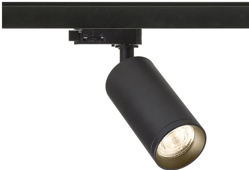
Spot cylindrique pour rails triphasés. Adapté aux ampoules à culot GU10. Le système à ressort de la douille permet d'accepter des ampoules de différentes longueurs.
