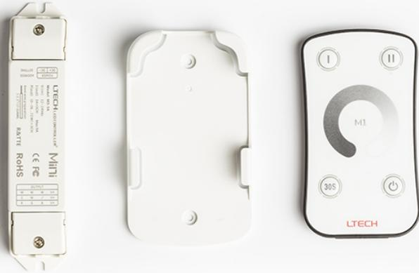
Fernbedienung für LED-Bänder 12V =. Mit Lichtintensitätssteuerung. Geeignet für LED-Bänder G12366, G12367, G12371, G12372, G13798 oder G13799.
