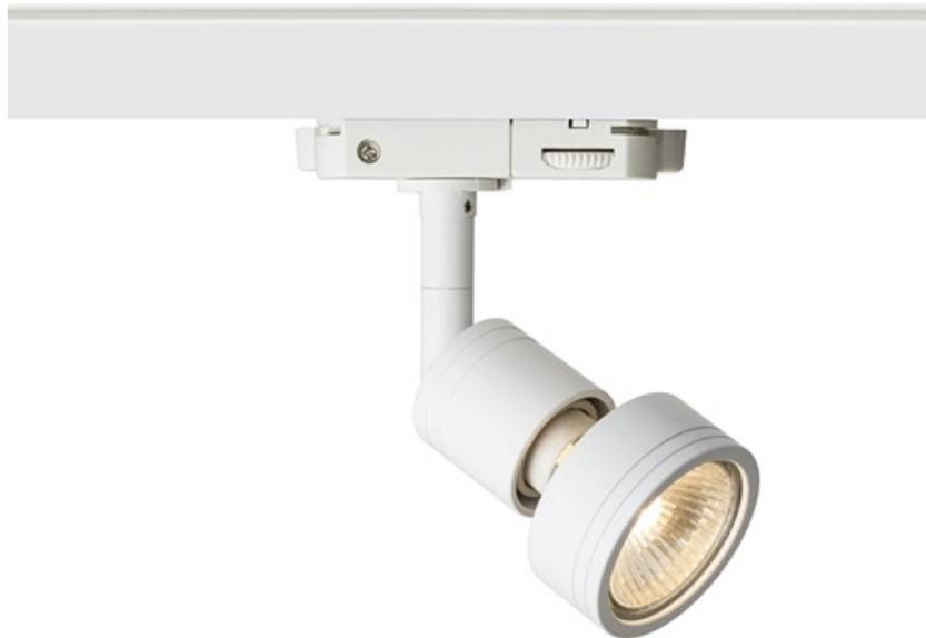
Die Leuchte für 3-Phasen-Stromschiene in drei Farbvarianten. Wird mit dekorativem Ring mit GU10 Fassung und Reflektordurchmesser 51 mm geliefert. ES111 Lichtquellen können ebenfalls verwendet werden.
