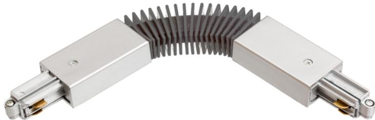
Connecteur flexible pour rail monophasé. Rayon de courbure 70°–180°. Charge maximale 16 A.
