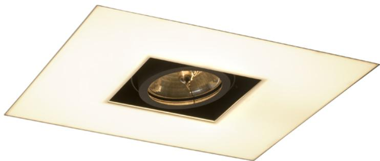
Faretto da incasso con diffusore plastico in color opalino. Per due sorgenti luminose: faretto 1x50W con filettatura G53 e tubo fluorescente 1x55W T5. Fornito con trasformatore e attuatore.
