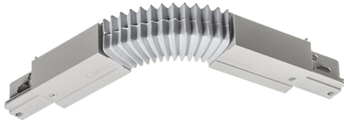
Articulação condutora flexível para calhas trifásicas EUTRAC. Raio 30 ° -330 °. Com esta ligação é possível alimentar o sistema de calhas. Carga máxima 16A.
