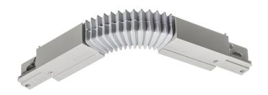
Flexverbinder geeignet für 3-Phasen Stromschiene EUTRAC. Radius 30 °-330 °. Mit diesem Verbinder ist es möglich, das Schienensystem anzuspeisen. Maximale Belastung 16A.
